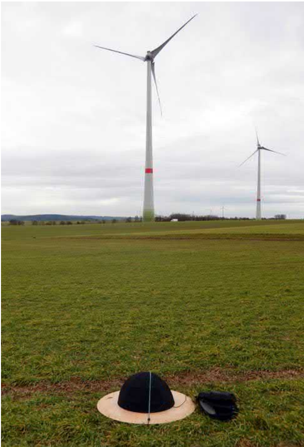
Abbildung 4.7-1: Windenergieanlage WEA 6 mit landwirtschaftlich genutztem Umfeld. Im Vordergrund erkennbar der Messpunkt MP1 mit schallharter Platte und doppeltem Windschirm. Foto: Fa. Wölfel
