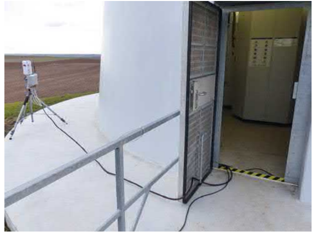
Abbildung 4.5-5: Während der Messung werden laufend im Inneren der Anlage Daten erfasst und per Funk übermittelt (links). Foto: LUBW
