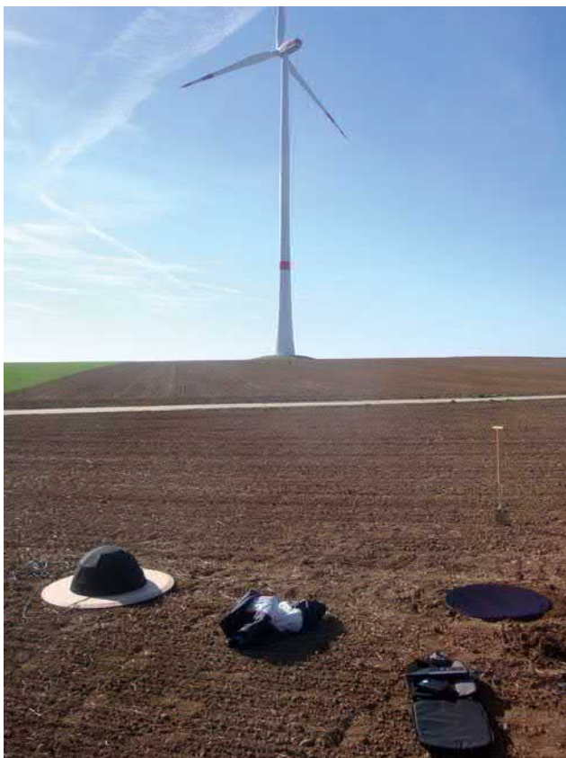
Abbildung 4.5-1 (rechts): Messpunkte MP2 und MP3 in 300 m Entfernung von der Turmachse. Schallharte Platte und doppelter Windschirm (links), überspanntes Erdloch (rechts). Foto: Fa. Wölfel
