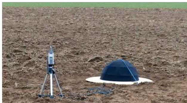
Abbildung 4.5-3: Schallharte Platte mit darauf montiertem Mikrophon und doppeltem Windschirm. Das eingesetzte Messgerät Typ DUO steht auf einem Stativ montiert daneben und ist über ein Messkabel mit dem Mikrophon verbunden. Foto: LUBW
