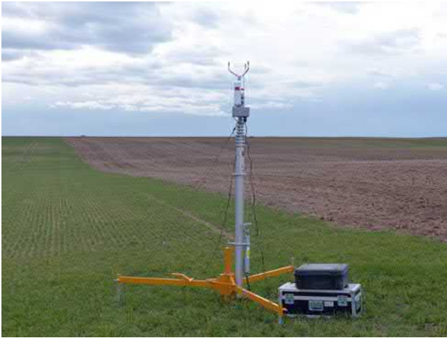
Abbildung 4.5-4: Windmessmast zur Messung von Windgeschwindigkeit und Windrichtung, Luftdruck, Luftfeuchte und Temperatur. Der Mast wird auf 10 m Höhe ausgefahren (hier noch nicht geschehen). Foto: LUBW
