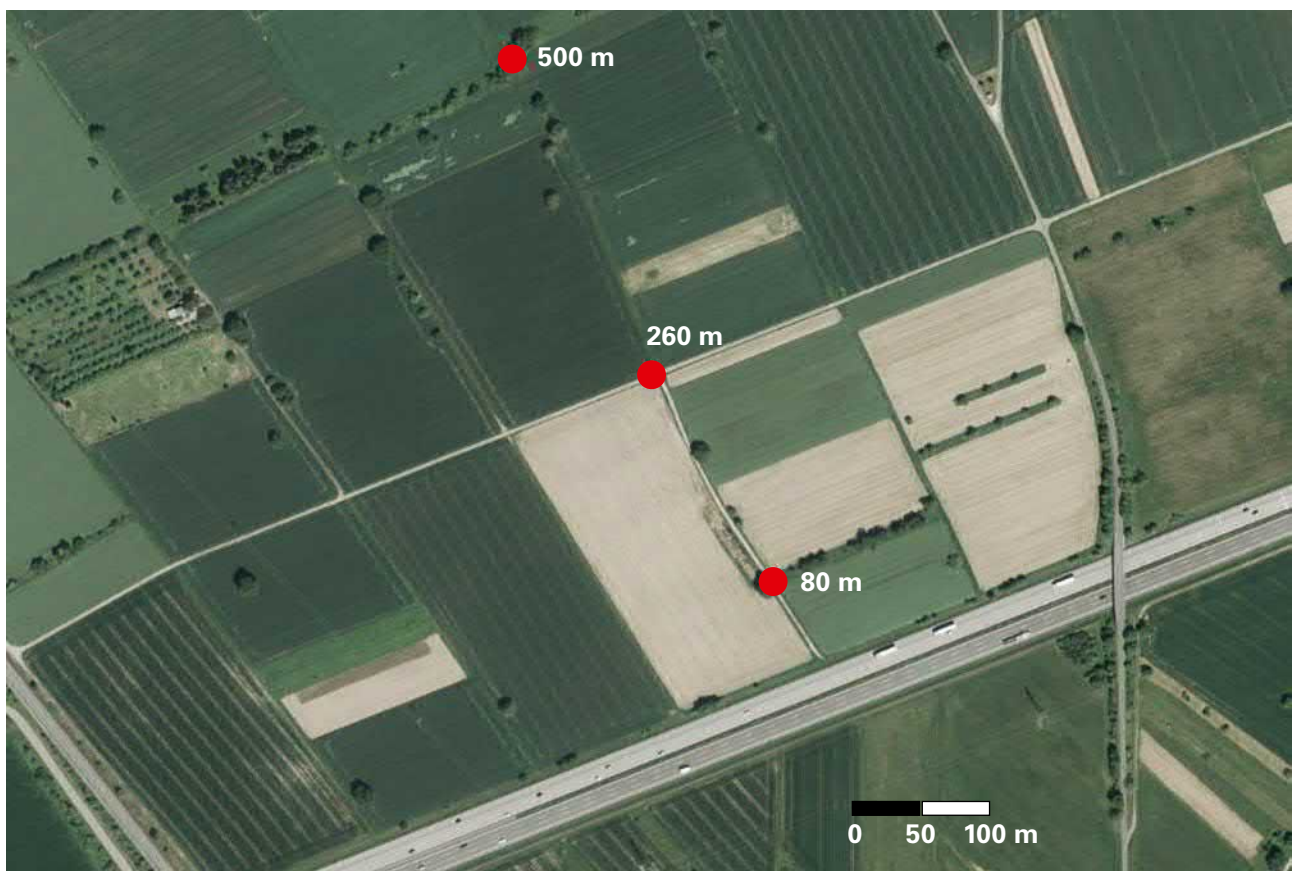
Abbildung 5.3-1: Lage der Messpunkte an der Bundesautobahn A5 südlich von Karlsruhe bei Malsch, mit Angabe der Abstände der Mikrofonpositionen zur Autobahnmitte. Die Gemeinde Malsch befindet sich außerhalb des Bildes links unten. Oberhalb des Bildausschnittes verläuft die Bundesstraße B3. Bildquelle: LUBW, LGL
