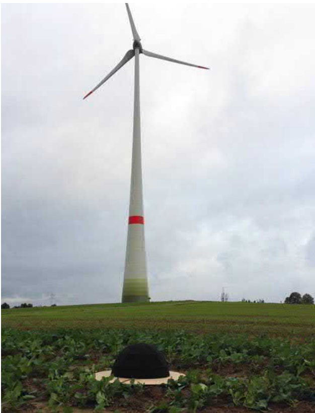
Abbildung 4.4-1: Windenergieanlage WEA 3 mit landwirtschaftlich genutztem Umfeld. Im Vordergrund erkennbar der Messpunkt mit schallharter Platte und doppeltem Windschirm. Foto: Fa. Wölfel
